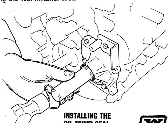
INSTALLING THE OIL PUMP SEAL
