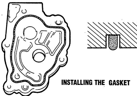
INSTALLING THE GASKET
