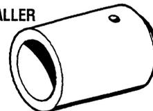
**OIL PUMP OIL SEAL INSTALLER**
